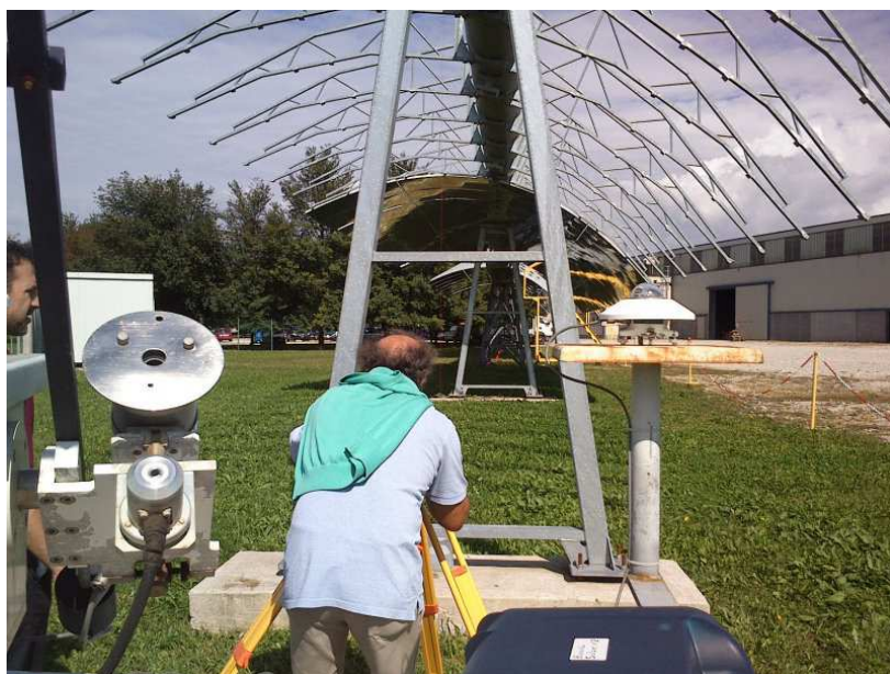
Figura – 9 Misure preliminari dell'azimut dell'impianto solare dimostrativo presso la ditta D.D. s.r.l.
