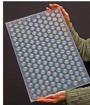
Figura 10 - Nell'immagine microconcentratori assemblati in un modulo in prova nel 2007 negli Stati Uniti (Foto Solfocus).
